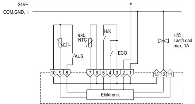
KTRRB-052.24x Anschluss im 4-Rohr-Leitungssystem
