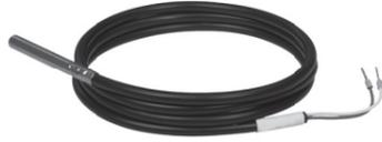
(Bitte beachten Sie die EMV-Richtlinien, Parallelverlegung mit Netzspannung führenden Leitungen vermeiden oder abgeschirmte Leitungen verwenden). In V2 A-Hülse eingegossen (außer ... K = Kunststoffhülse). Zeitkonstante ca. 20s, in bewegtem Wasser.
