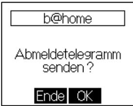
Die Abmeldefunktion kann bei dem b@home-Bedienteil FTRCUd-210.021 im Einstellungsmenü ausgewählt und durch Berührung der Tastfläche unterhalb **OK** gestartet werden.
